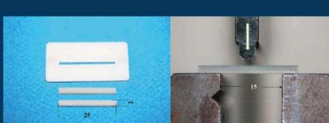
図6. 曲げ強さの測定用試験片と曲げ強さの測定方法
