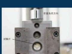
図5. 剪断試験方法
