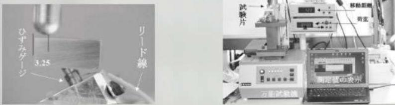
図2 D:インプラントにセットした上部構造、ひずみゲージは圧縮側にセット
