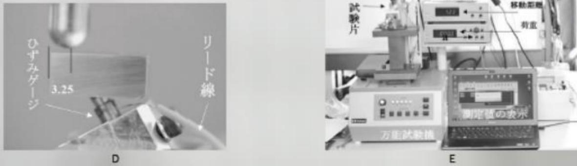
図2 D:インプラントにセットした上部構造、ひずみゲージは圧縮側にセット
