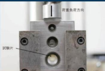
図5, 剪断試験方法
